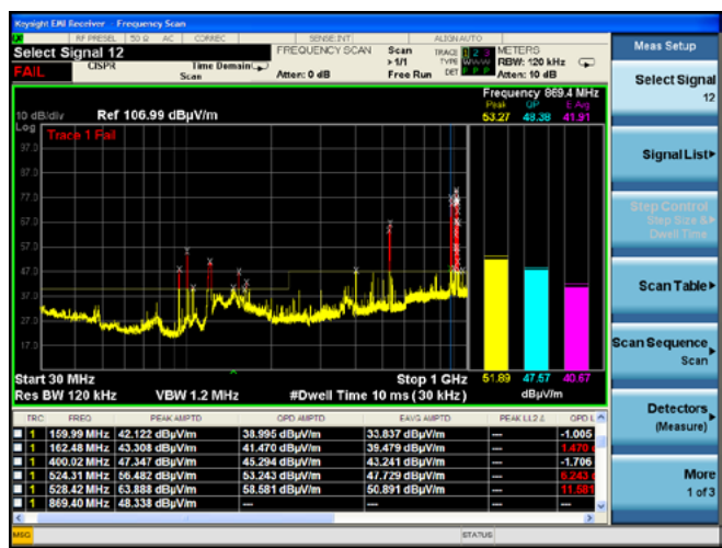
Рисунок 1-6. Сравнение измеренных уровней излучаемых ЭМП с пределами, установленными стандартом CISPR11, как часть методики тестирования ЭМП.
