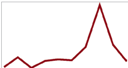
Рисунок 2-20. Режим детектирования мгновенного значения, использующий 10 точек для отображения сигнала, представленного на рисунке 2-17.
